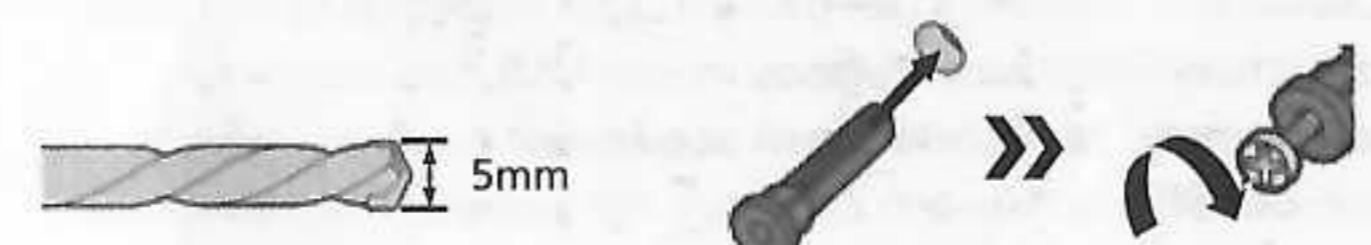
2. Просвердліть отвори свердлом Ø5 мм.
