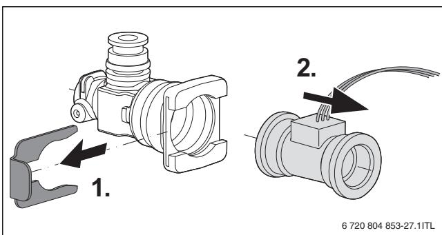
Мал. 64 Демонтаж турбіни на трубі холодної води
