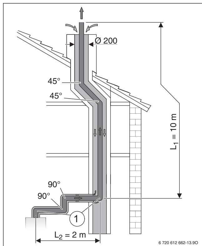
Мал. 17 Приклад встановлення трубопроводу для відведення димових газів у шахті згідно з C<sub>93</sub>
