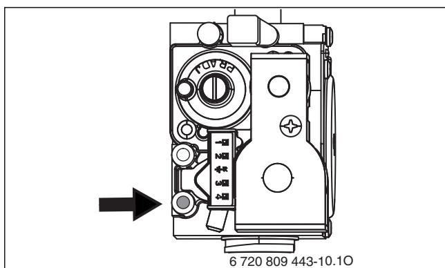
Мал. 48 Штуцер для вимірювання тиску підключення газу
