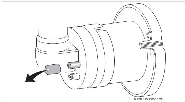
Мал. 51 Штуцер для вимірювання на змішуvalній камери
