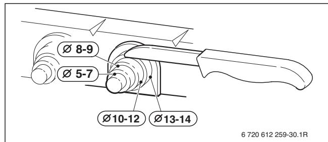
Мал. 29 Підгонка фіксатора проводу до діаметра кабелю
