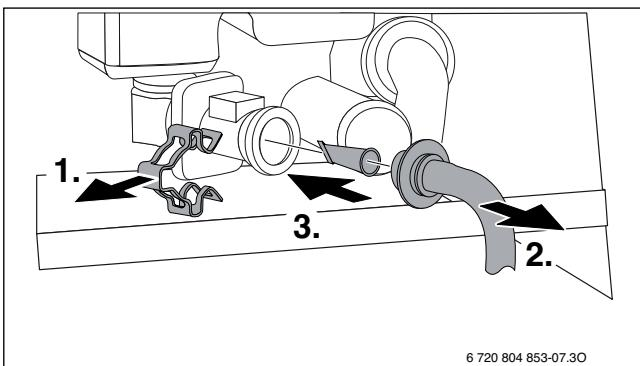
Мал. 63 Демонтаж фільтра в трубі холодної води
