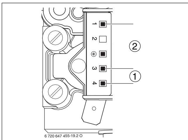
Мал. 68 Точки вимірювання на газової арматурі
