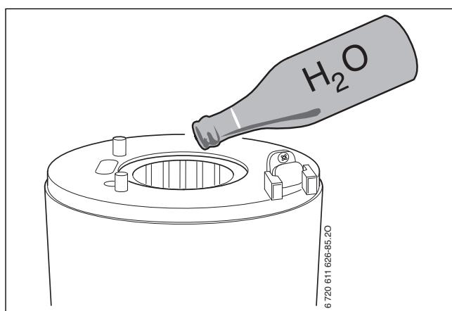
Мал. 59 Промивання водою котлового блока, який включає камеру згорання і теплообмінник
