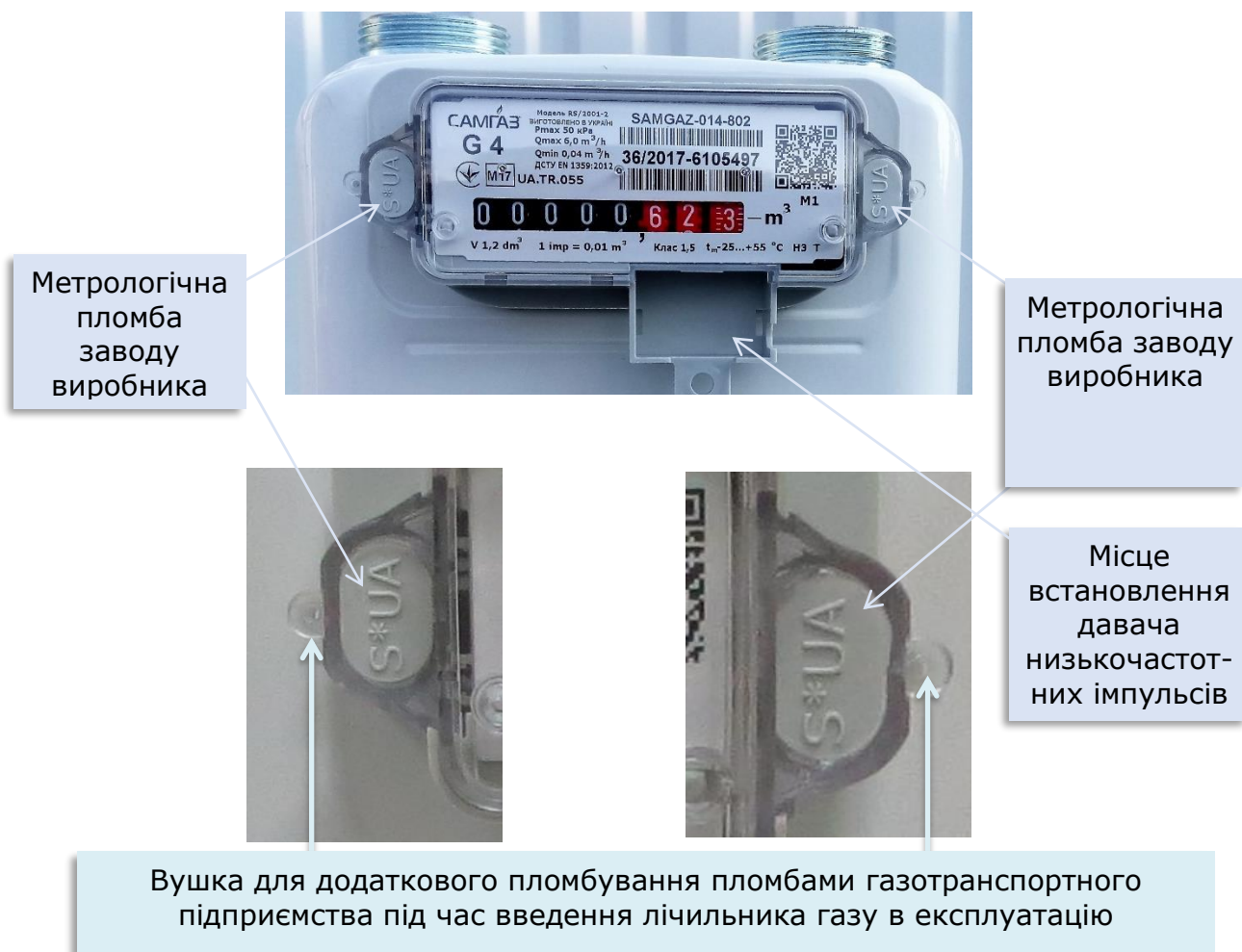
Рис. 11 Схема пломбування лічильників
