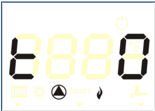
Работа в режиме „Трубочист” с минимальной мощностью
