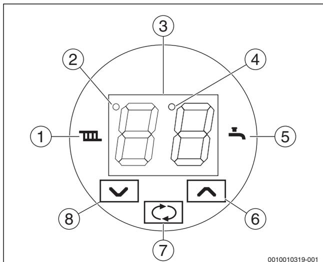
Рис. 31 Панель управления котла Tronic Heat 3000/Tronic Heat 3500
