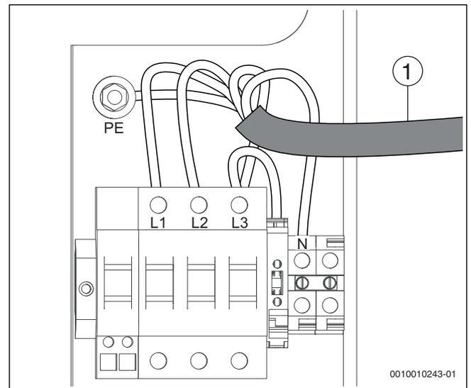
Рис. 16 Подключение к электросети 4...24 кВт, 3x 400/230 В ~
