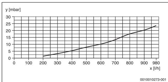
Рис. 34 Гидравлическое сопротивление Tronic Heat 3000/ Tronic Heat 3500 15–24 кВт
