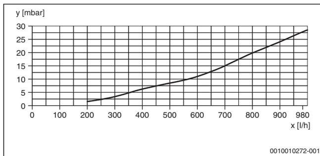
Рис. 33 Гидравлическое сопротивление Tronic Heat 3000/ Tronic Heat 3500 4–12 кВт
