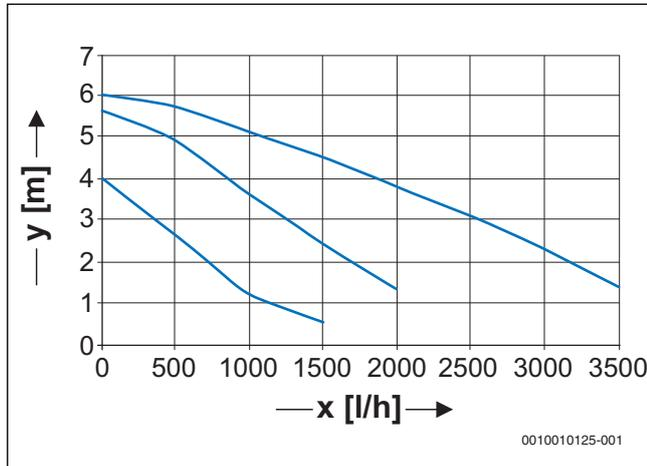
Рис. 32 Напор насоса Wilo RS15/6-3 для отопительного котла Tronic Heat 3500 4–24 кВт
