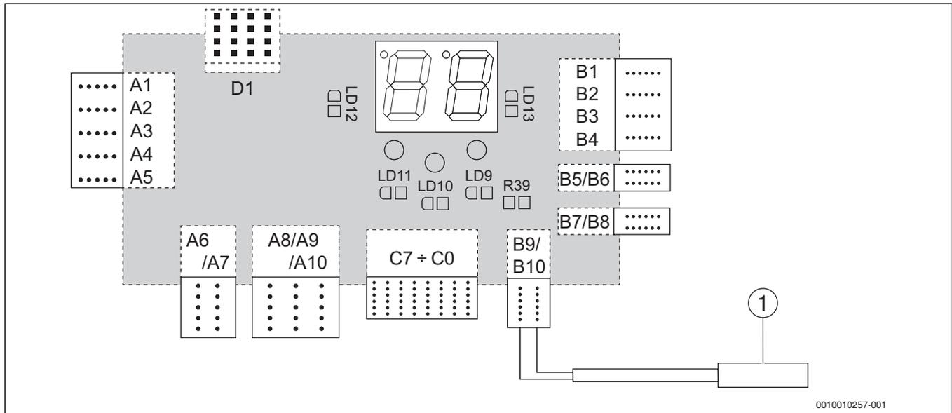
Рис. 30 Подключение внешнего датчика минимальной температуры в помещении
